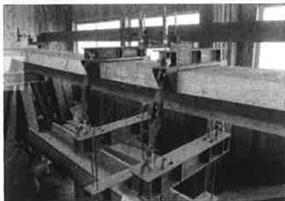
長期たわみ計測試験体
